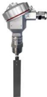
Реле потока GE-341 использует новую структуру, может контролировать поток в двух направлениях. Он управляется микромагнитным герконовым переключателем, он нормально открыт. Когда проточная вода нажимает на лопасть, структура передачи меняет состояние переключателя, он закрывается. Прибор может быть взрывозащищенным, ExdIICT6 или ExdII BT4. Сертификат АTEX для реле потока, сертификат UL для микропереключателя.
