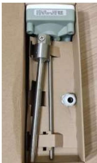
Датчик разработан по высоким стандартам качества. Материалы и техника сборки заимствованы у промышленного сектора. Зонд изготовлен из нержавеющей стали со сварным наконечником. Зонд обжигается в печи и обрабатывается эпоксидной смолой во избежание проблем, возникающих от долгого пребывания в воде.
